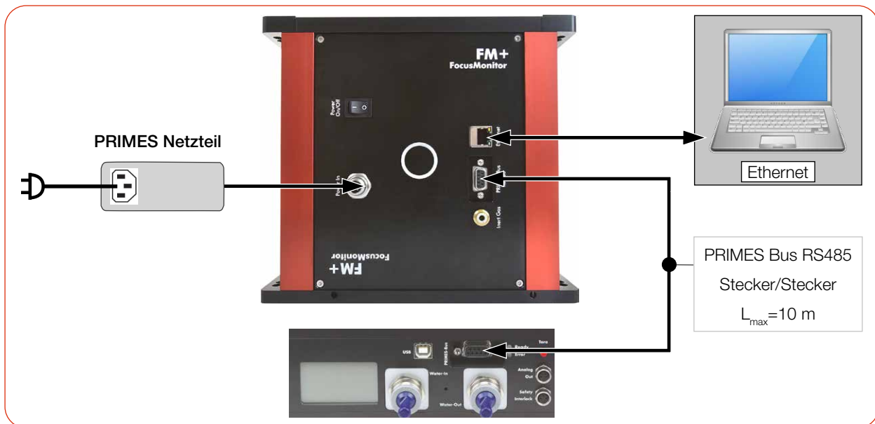
Abb. E.1: Anschluss des FocusMonitor FM+ mit dem CPM (am Beispiel des CPM F-10)
