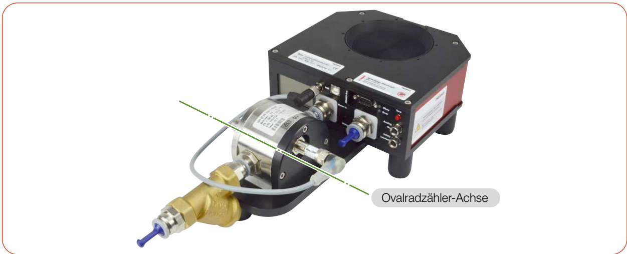
Abb. 6.1: Position der Ovalradzähler-Achse (am Beispiel des CPM F-10)
